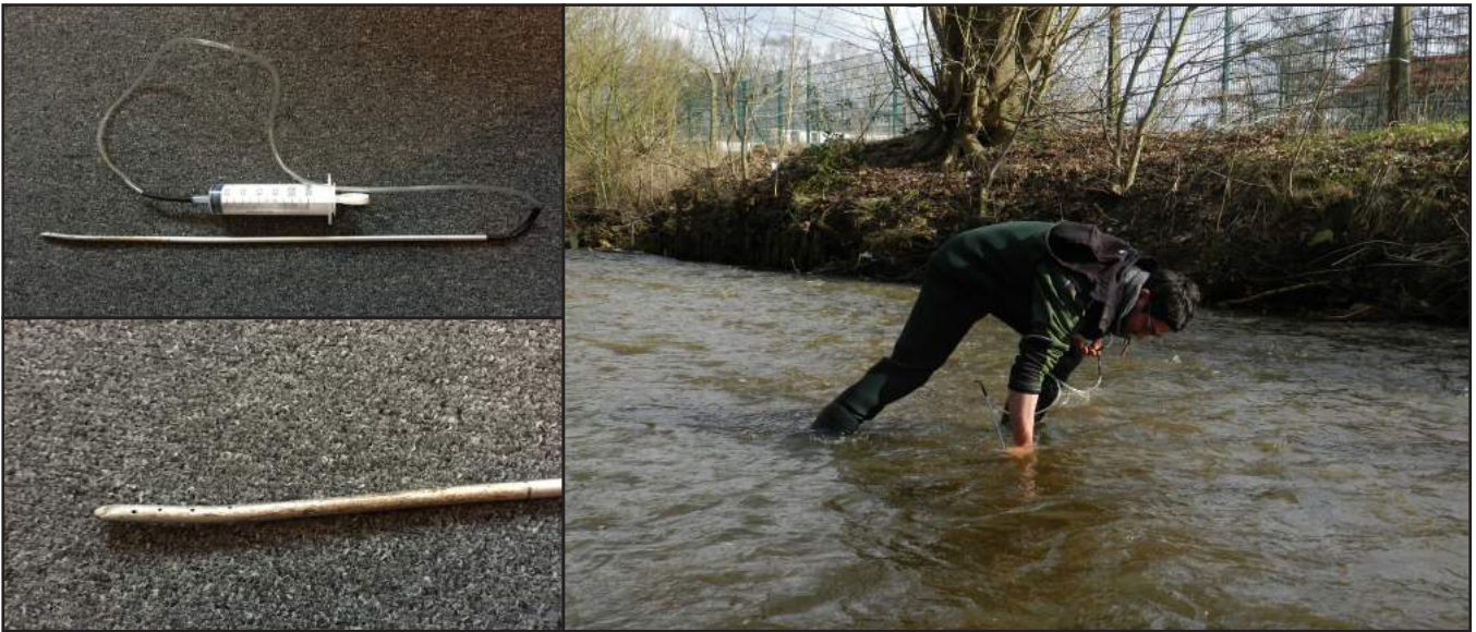
Abb. 24: Vorrichtung zur Interstitialwasserentnahme nach RENNEBECK (2015)
