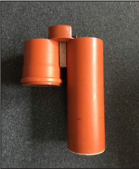
Abb. 22: „Excavation-core-Sampler“ nach RENNEBECK (2015)
