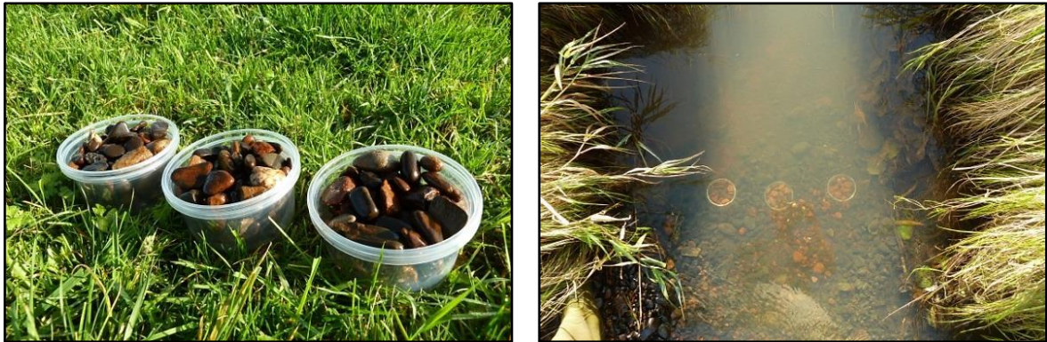
Abb. 11: Mit Kies gefüllte Becher (250 ml) wurden in die Gewässersohle eingebracht, um verdriftendes Sediment zu sammeln.
